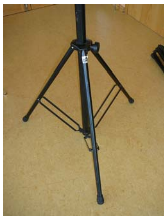
2. Das Dreibein öffnen, indem man die Dreibeinplatte nach unten schiebt. Dann die Klemmung wieder anziehen.
